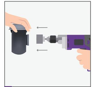
**4.** Realiza el orificio en la boca de salida correspondiente con una mecha copa de 1-3/8 o 1-7/16" (35 mm).
