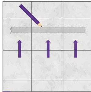
**3.** Presenta la canaleta y marca el contorno del desagüe en la superficie donde harás la instalación. La profundidad de la canaleta es de 3-3/8" (85 mm).
