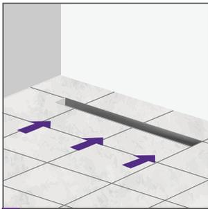
**1.** Determina el lugar donde será instalado el desagüe lineal. La posición en el box de ducha puede ser en el sector posterior, al frente o en el centro.
