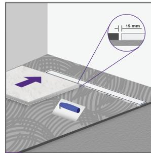
**11.** Instala los cerámicos dejando +/- 1/4" (5 mm) de junta con el borde de la canaleta. Para garantizar el flujo correcto del desagüe, los cerámicos deberán ubicarse a una altura de 1 mm mayor que la parte superior del desagüe. La instalación puede realizarse con cerámicos de hasta 3/8" de altura (9 mm). El sellado entre el suelo y el revestimiento debe ser elástico e impermeable.
