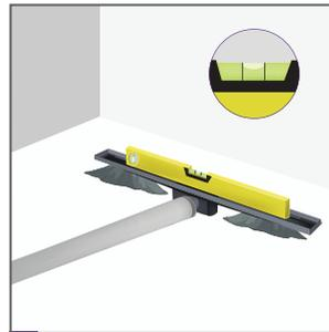
**7.** Vierte la mezcla de mortero en la parte inferior de la base del desagüe para dar soporte y asegurar la nivelación.
