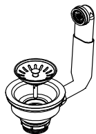
Válvulas 3 1/2" Con rebalse en la cubeta
